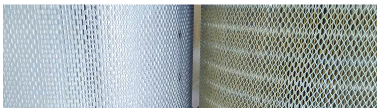
Nachfilter für Schneidölnebel links neu — rechts verbraucht
